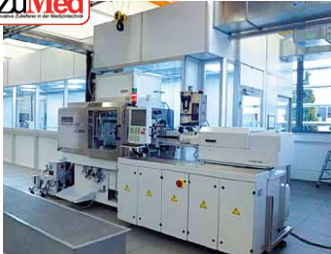
Spritzgussmaschine der Firma Scholz: Für die Fertigung im Reinraum nach Klasse EU GMP C.
